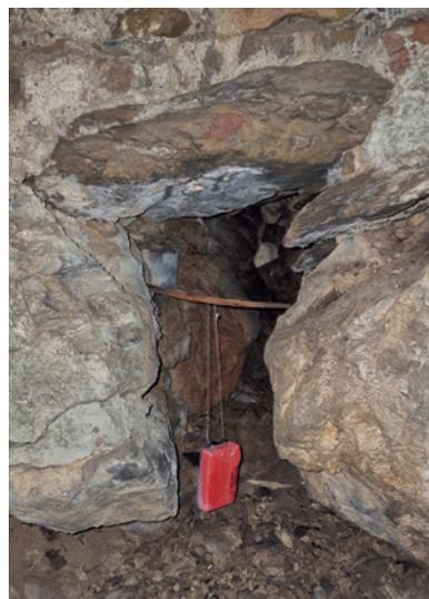
*Die etwa 60 cm hohe und 30 cm breite Felsspalte im bergseitigen Teil des Cheltiheysli, aus der vom Frühjahr bis Spätherbst kalte Luft ins Gebäude strömt. Hier wurde über Jahre hinweg mit einem Logger (rotes Gerät) die Temperatur im Stundentakt gemessen.*
